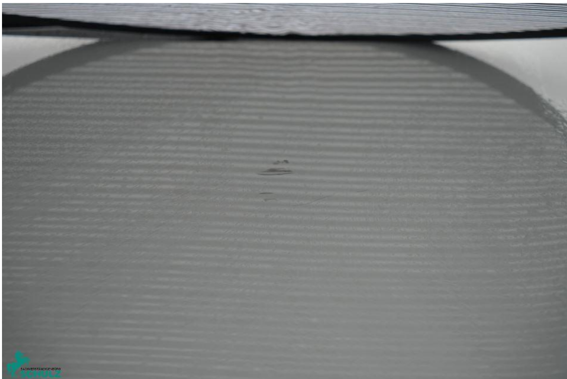
Foto 14: keine Deformationen an Motorhaube sichtbar
