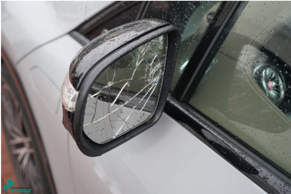
Foto 11: Außenspiegel l. beschädigt
