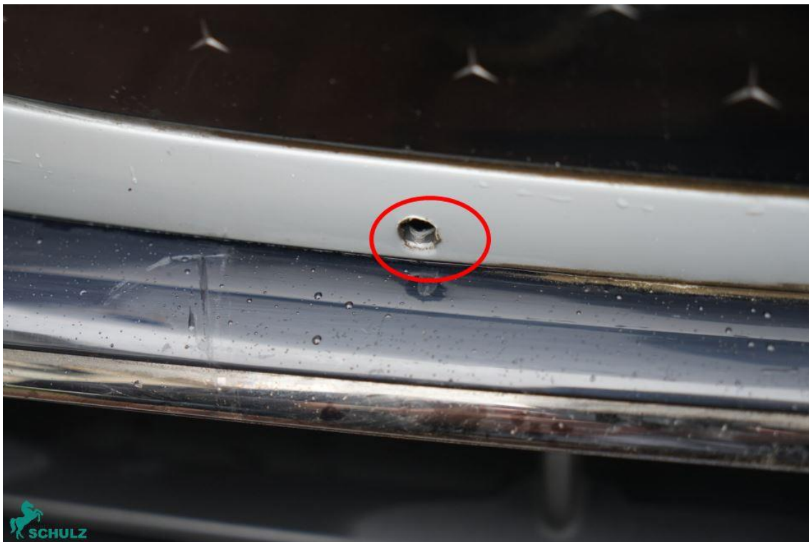
Foto 14: Befestigungsloch vorn rechts "geweitet"
