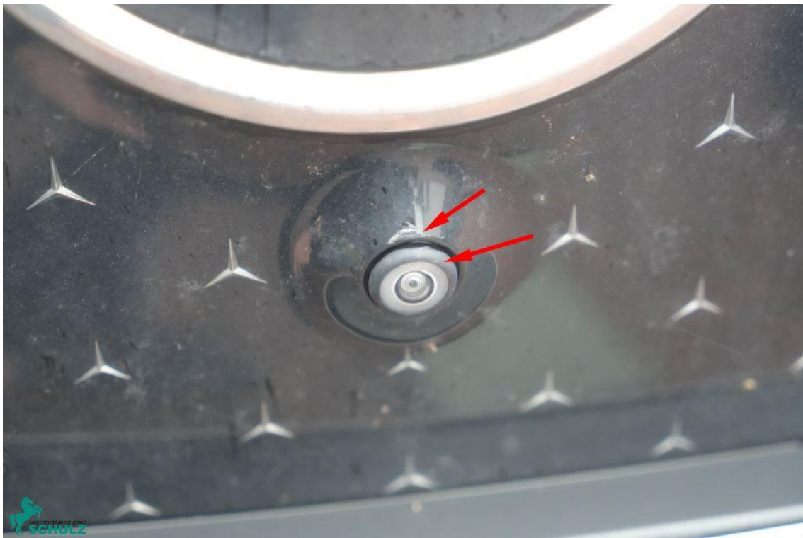
Foto 10: 360Grad Kamera vorn verschrammt
