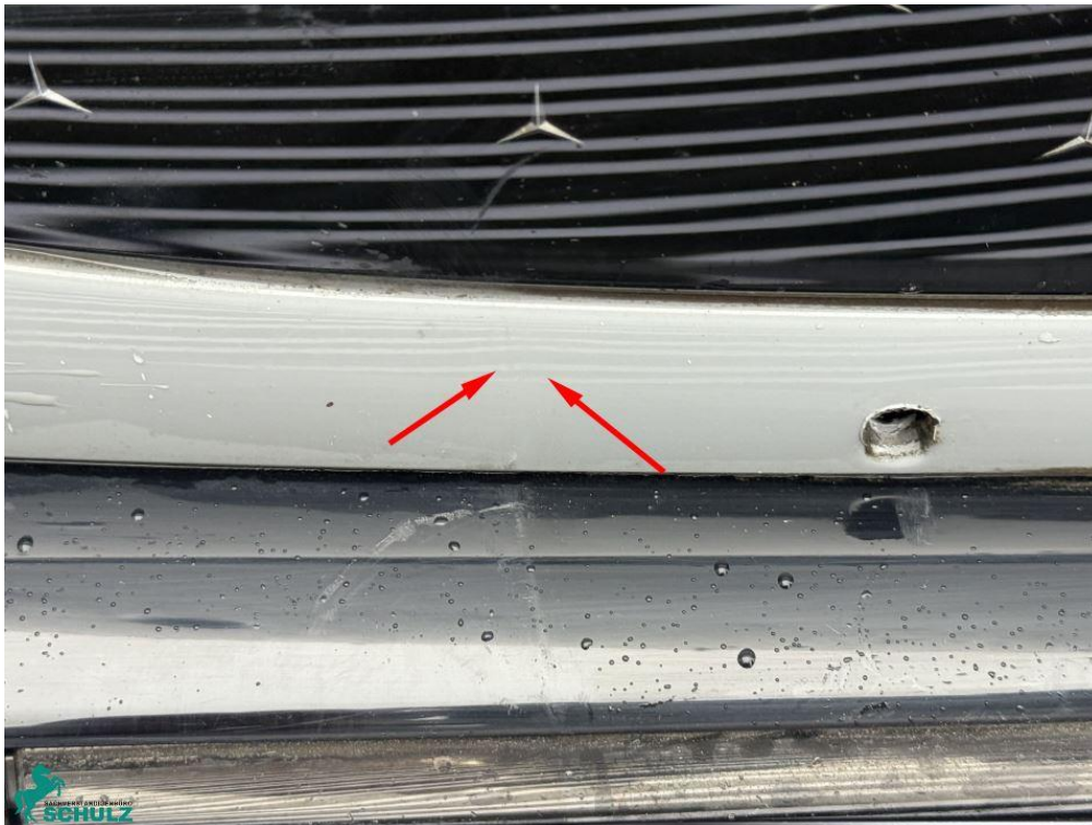
Foto 12: Frontverkleidung verschrammt u. plastisch verformt
