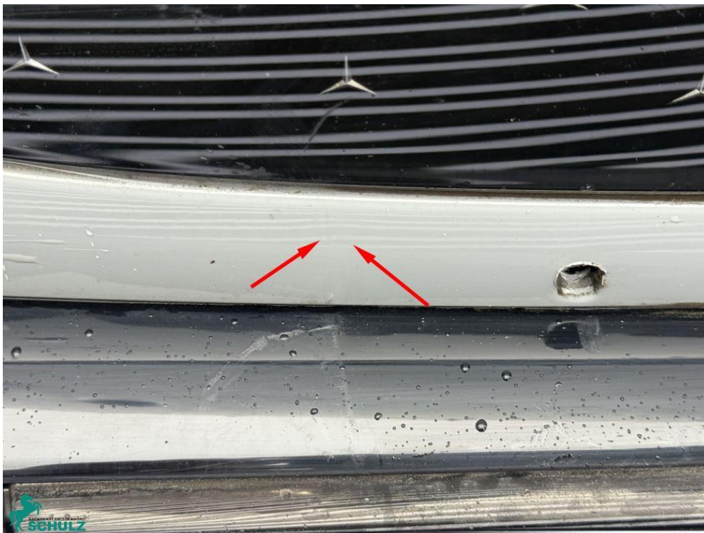
Foto 12: Frontverkleidung verschrammt u. plastisch verformt
